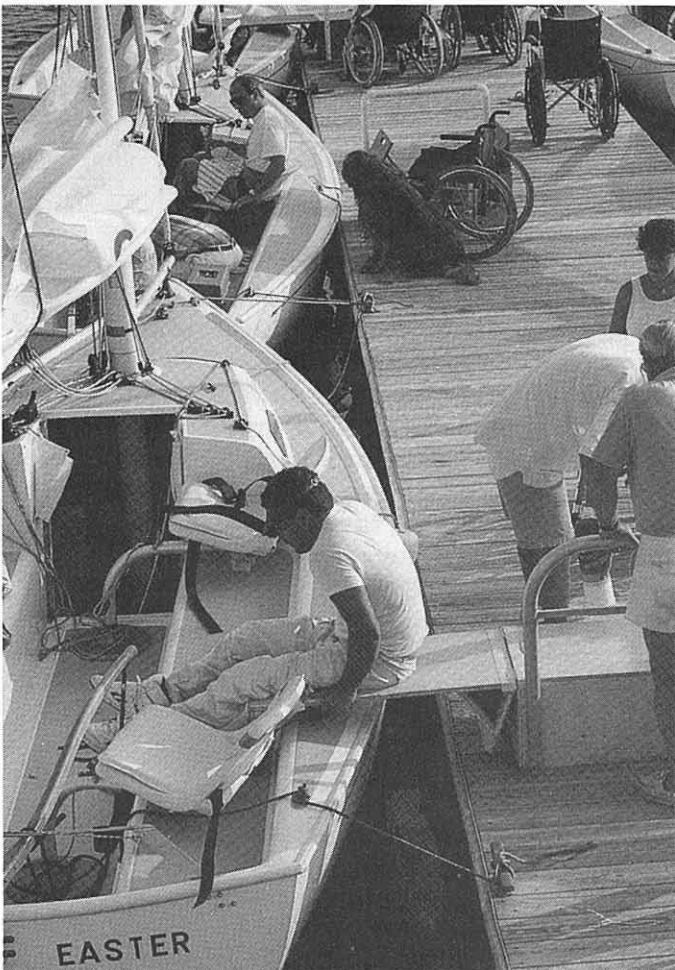
Yhdysvalloissa vammaisille suunniteltu Freedom Independence purjeverene. Veneessä on vakiovarusteena kaksi kääntöistuinta, joiden avulla liikkumisesteinen purjehtija pääsee helposti siirtymään veneen laidalta toiselle. Mitat: pituus 6.25 m, leveys 2.45 m, syväys 1.15 m, paino 945 kg, purjehdusala n. 20 neliometriä, uppoamaton.
