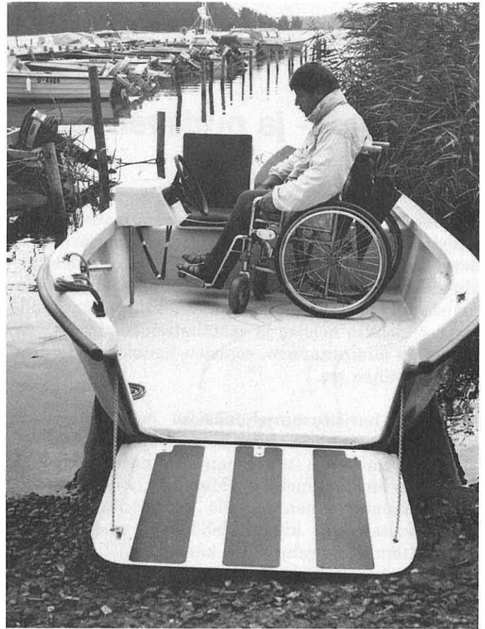
Suomalainen pyörätuolia käyttäville suunniteltu moottorivene. Veneeseen tulo ja maihinnousu onnistuu vain matalassa rannassa tai sopivalla luiskalla. Mitat: pituus 4.60 m, leveys 1.75 m, paino noin 240 kg. Itsetyhjentyvä.
