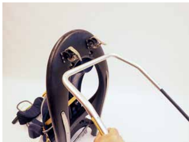
Fjellpulkenin aisoja käytettäessä välineeseen kiinnitetään muoviset, hihnalliset vetoaisan kiinnikkeet, joihin aisa tulee kiinni.
