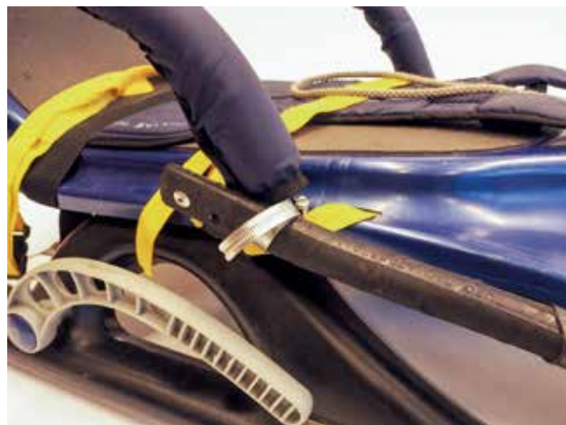
HIT:n vetoaisat on kiinnitetty kiristämällä putkiklemmari aisan ja välineessä olevan putken ympärille.
